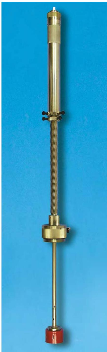
Zařízení s jednoduchým posuvem a pilovou frézou uvnitř bloku. Celková délka je 126 cm.
